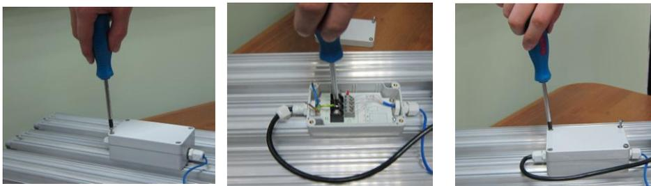
Рисунок 2 Порядок подключения светильника
